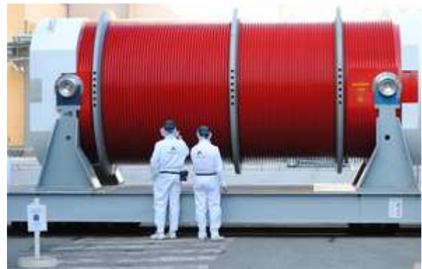
Colis de type CASTOR® HAW28M contenant des déchets vitrifiés
