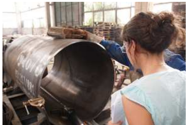
Inspecteur de l'ASN contrôlant un cylindre 30B en fabrication dans un atelier en Roumanie
